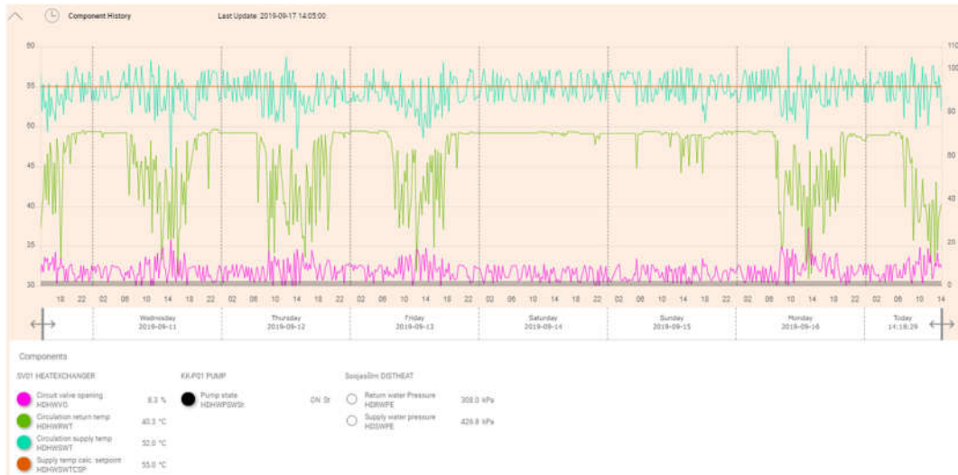
Joonis 14. Lubja 4 sooja tarbevee peale- (HDHWSWT) ja tagasivoolu (HDHWRWT) temperatuur, seadepunk ja ventiili asend (HDHWVO) nädala jooksul.
