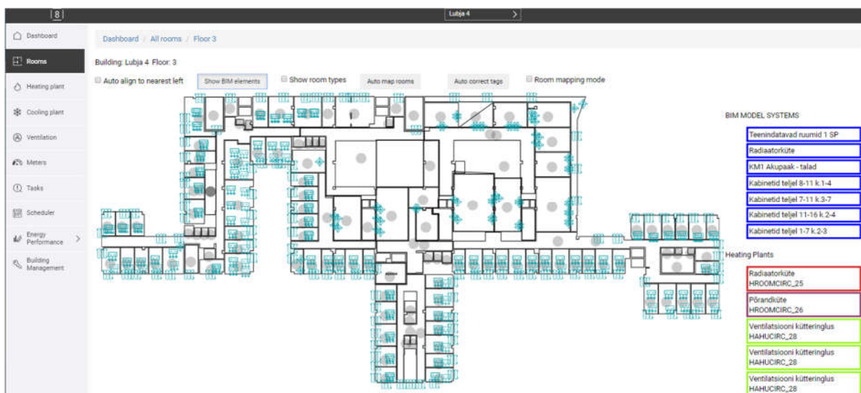
Joonis 3. Infomudeli põhjal süsteemi arhitektuuri konstrueerimine R8 platvormil.
