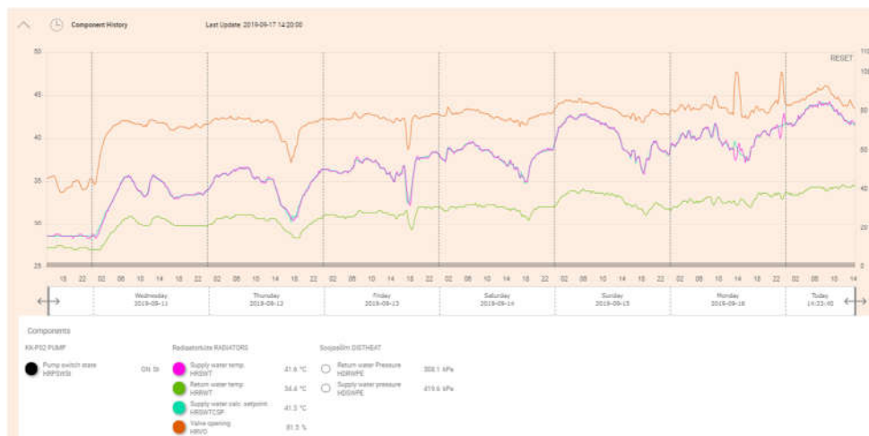
Joonis 15. Lubja 4 radiaatorkütte peale (HRSWT)- ja tagasivoolu (HRRWT) temperatuur, seadepunk (HRSWTCTSP) ja ventiili asend (HRVO) nädala jooksul.
