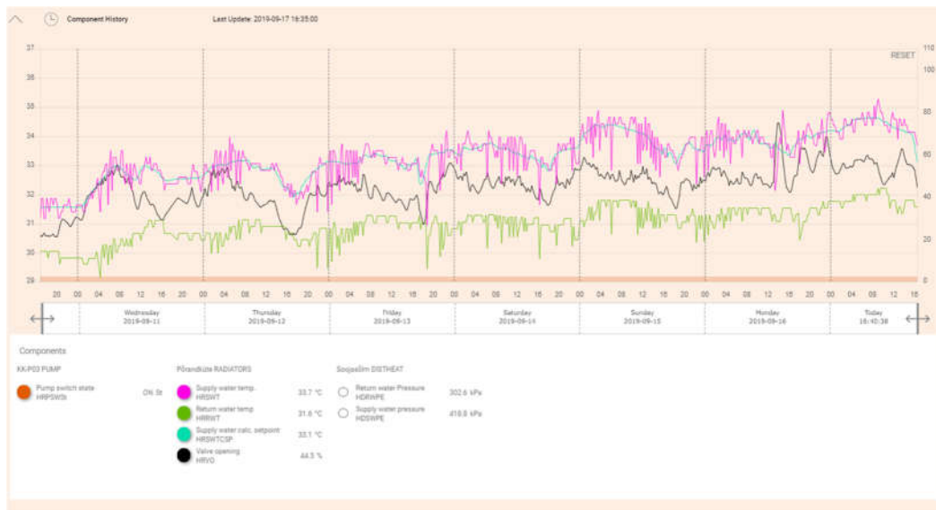
Joonis 17. Põrandkütte vee peale (HRSWT)- ja tagasivoolu (HRRWT) temperatuur, seadepunkt (HRSWT CSP) ja ventiili asend (HRVO) nädala jooksul.
