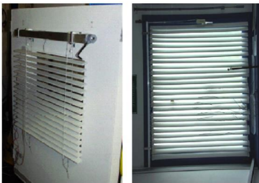
Joonis 2.28 Faasimuutusega soojust salvestavat materjali sisaldavad ribikardinad
