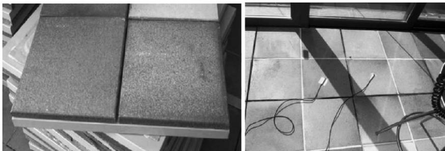
Joonis 2.24 Faasimuutusega soojust salvestavad plaadid
