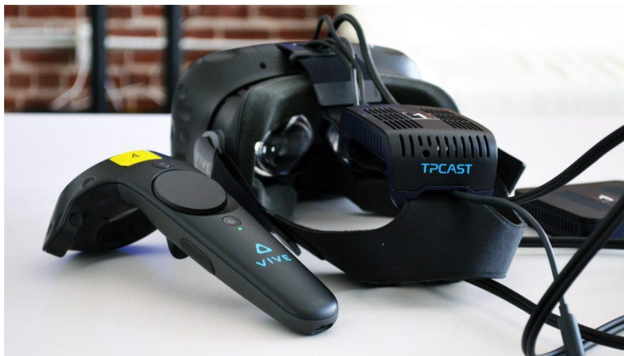
Foto 13. TPCAST juhtmevaba ühendus HTC Vive peakomplektile [12]
