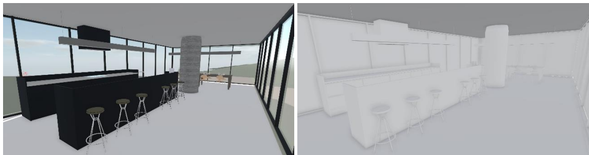
Joonis 27. Vasakul Reviti näidismaja sisevaade modelleeritarkvara vaates ja paremal sama hoone viidud visualiseeritarkvarasse .fbx failiformaadi abil
