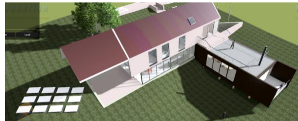
Joonis 163. Revitis teostatud ning Fuzorisse kandunud katuse pikendamine
