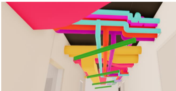
Joonis 110. Tehnosüsteemid VRG koridoris, kus mudel on viidud Enscape'i SketchUpi kaudu – osad torupõlved on puudu
