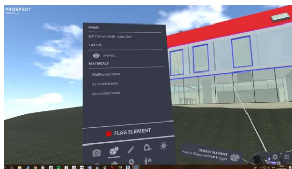
Joonis 19. Elemendi valikusse võtmine ning selle parameetrite kuvamine teise puldi menüüs
