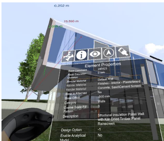
Joonis 142. Elemendi parameetrite kuvamine
